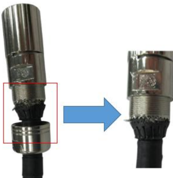
Rys.5 .17 : Ekrany muszą mieć przewodzące połączenie z okrągłym złączem
